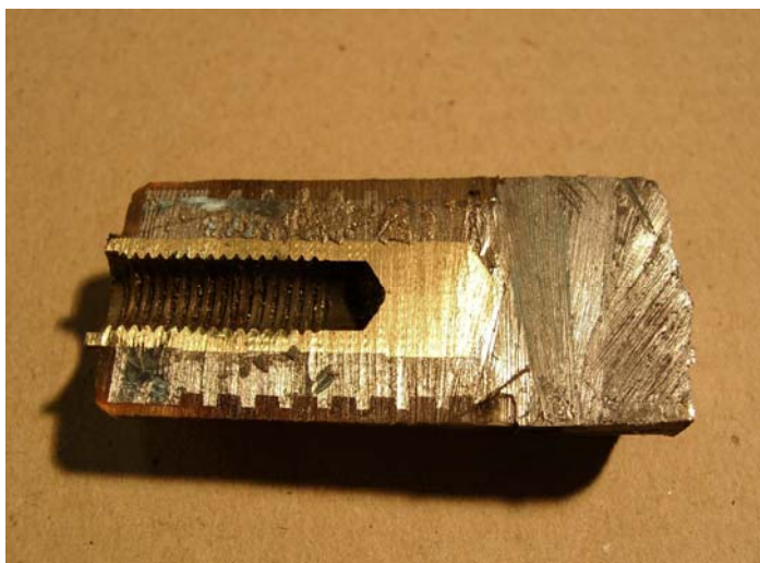
VAE OPzS положительный полюс через 550 дней ускоренного старения. 550 дней при температуре T = 62,8^{\circ}\text{C} соответствует 42,6 годам эксплуатации при 20^{\circ}\text{C} . Отслоение полимерного покрытия отсутствует.
